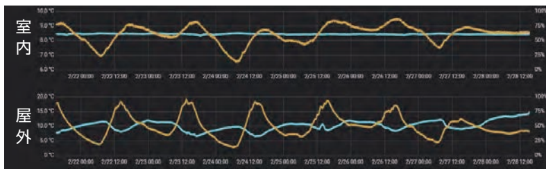
図-2 建物・倉庫の室内・屋外の温湿度
