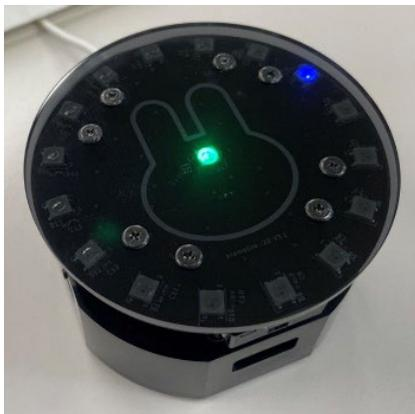
LED 表示パネル部の LED により風向と風速を直感的に表示します。
