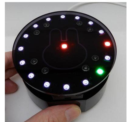
・プッシュスイッチを長押しして千／百の桁の設定を確定します。
