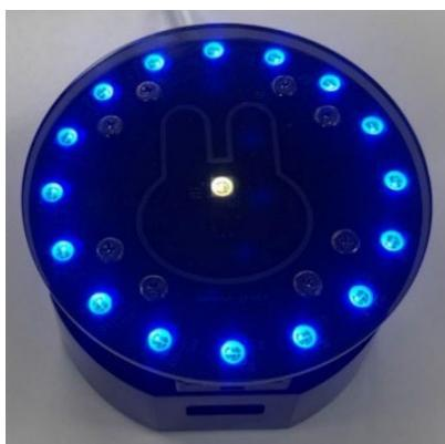
風速が計測範囲以上になると、すべての LED が点滅し計測範囲外であることを表示します。
